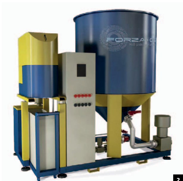
2_ Tra i prodotti di punta del catalogo di Forza G, il sistema compatto di separazione solido-liquido per il riciclo al 100% dei liquidi refrigeranti da molatura del vetro Tornado T48 M
